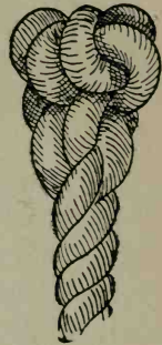
FIG. 116.—Wall knot (tucked).
